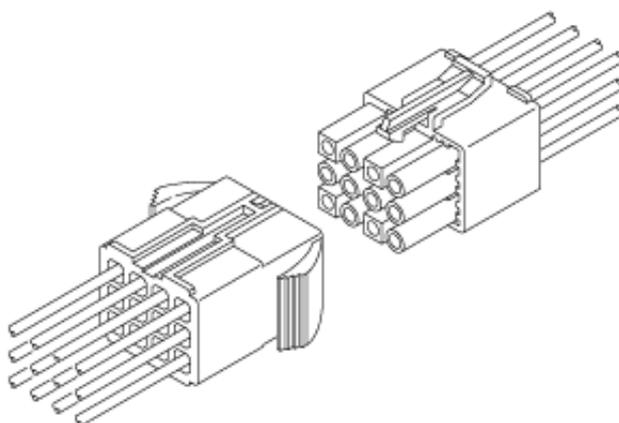
**Рисунок 3** – Схема интерфейсных разъемов MT-600
